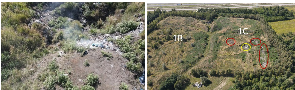
Fot. 3.22. Tłące się odpady na składowisku gipsów i popiołów (zdjęcie z lewej) oraz lokalizacja wypalonych kraterów (czerwony) i krateru dymiącego podczas wizji lokalnej (żółty) (zdjęcie z prawej).
