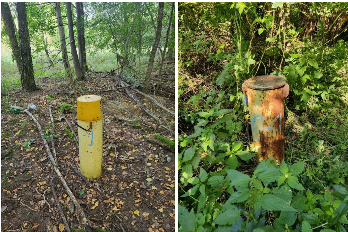
Fot. 3.27. Zdjęcia piezometru S9 (zdjęcie z lewej) i S1 (zdjęcie z prawej).
